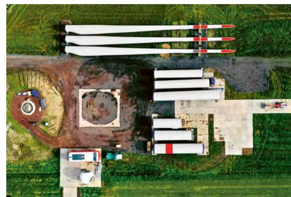
**Erneuerbares Puzzle:** Jede der Nordex-Anlagen – oben ist eine noch in ihre Einzelteile zerlegt zu sehen – hat eine Leistung von 4,5 Megawatt und eine Nabenhöhe von 125 Metern.
